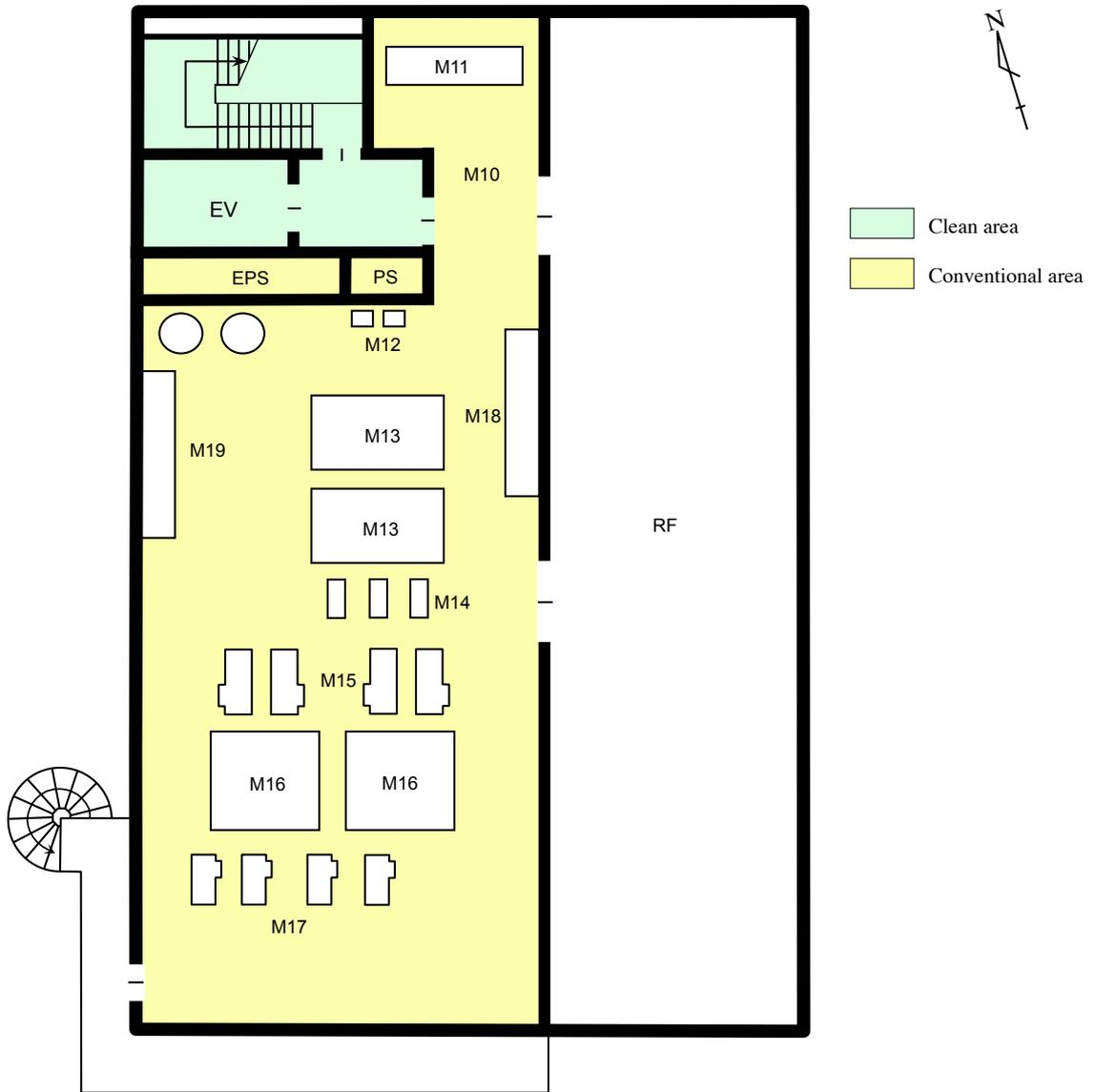
EV : Elevator    EPS : Electric pipe shaft    PS : Pipe shaft    RF : Roof floor
