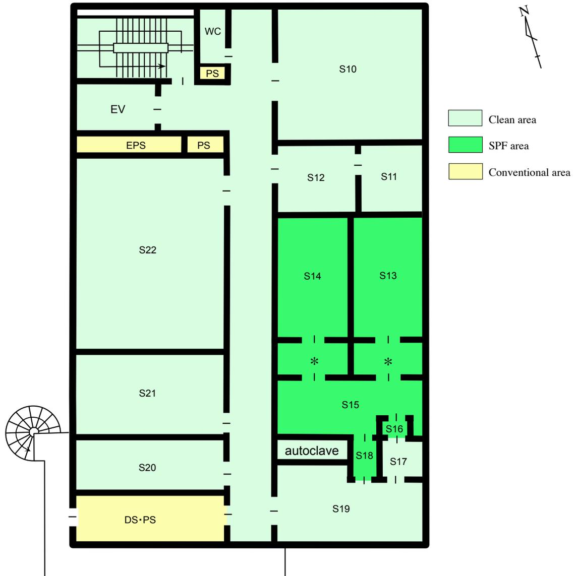
EV : Elevator    EPS : Electric pipe shaft    PS : Pipe shaft    DS : Duct space    \* : 前室 Anteroom
