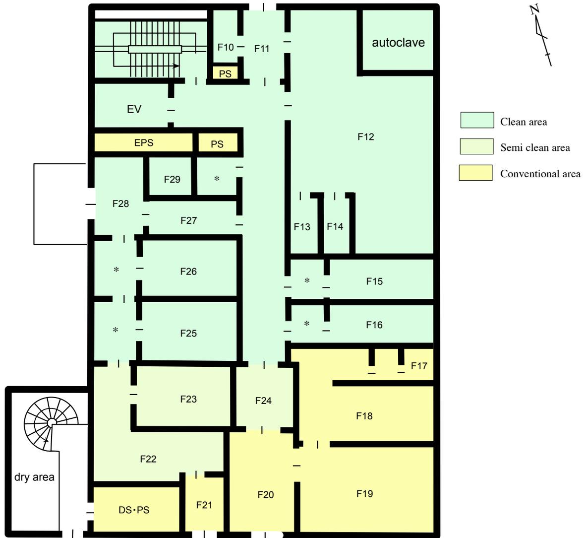
EV : Elevator    EPS : Electric pipe shaft    PS : Pipe shaft    DS : Duct space    \* : 前室 Anteroom
