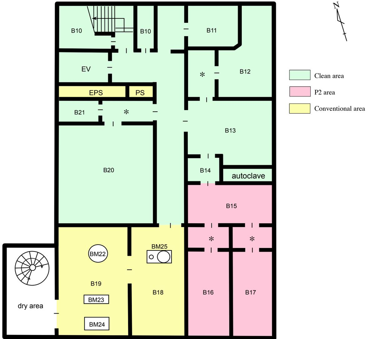
EV : Elevator    EPS : Electric pipe shaft    PS : Pipe shaft    \* : 前室 Anteroom
